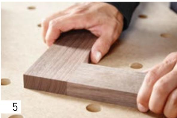
После этого склейте бруски обвязки рамы и при необходимости зажмите их, используя проставки и струбцины (для лучшего схватывания клея).
