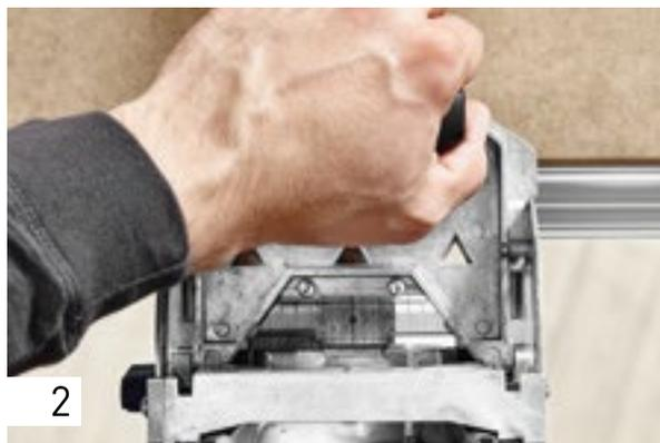
Наряду с уже известными способами фрезерования по разметке или с упорами пазы можно также выполнить по шкале в смотровом окошке – в этом примере на расстоянии 15 мм от наружного края. Для этого приложите шкалу меткой 15 мм к краю заготовки.
