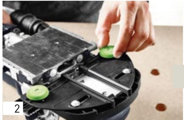
Отрегулируйте ширину упора под толщину стойки, настроив направляющую в боковом упоре посредством шкалы и колесиков зелёного цвета. В этом примере обрабатываются стойки квадратного сечения 30 x 30 мм.
