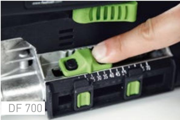
**DF 700:** для регулировки глубины фрезерования нажмите одну или обе кнопки-фиксаторы. Установите ползунок для регулировки глубины фрезерования на нужную глубину фрезерования. Допустимая глубина фрезерования для DF 700 составляет 15–70 мм. Теперь отпустите кнопки-фиксаторы – быстро проверьте, зафиксирован ли ползунок.
