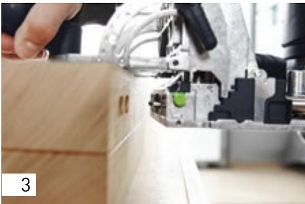
Изготовьте в ножках стола/кровати пазы DOMINO глубиной 25 мм. Один паз предназначен под анкерный болт углового соединителя; в другие пазы вставляются обычные шипы DOMINO для переноса на них нагрузки.
