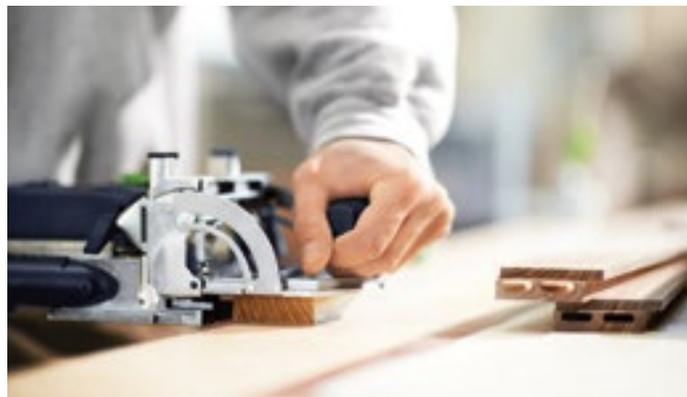
**СОВЕТ** Если затем в брусках обвязки рамы будут выбираться пазы или четверти, то при фрезеровании отверстий под шипы следует учитывать глубину четверти, чтобы шип встал по центру с учётом её размера.
