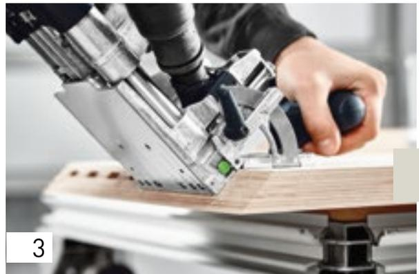
После изготовления первого паза (упорный стержень здесь примыкает к кромке заготовки) следует последовательно вставлять упорный стержень в готовые пазы – таким образом обеспечивается нужный упор при каждом последующем фрезеровании. Выполните первый паз точно по размеру, все последующие – с зазором в виде продольного отверстия.
