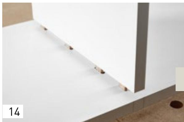
Аналогично обработайте вторую боковину. Теперь вставьте шипы DOMINO в пазы и соедините детали заготовки с добавлением клея.
