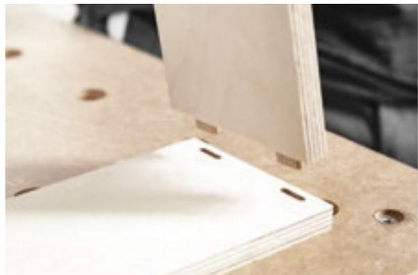
Соедините части заготовки и смажьте соединение клеем.
