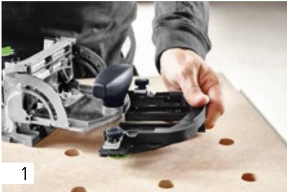
Установите упор на дюбельный фрезер DOMINO, как указано в руководстве по эксплуатации.
