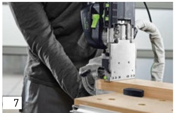
Теперь изготовьте поперечный паз в царге в месте установки соединителя. Для этого приставьте опорную плиту спереди к кромке заготовки и выровняйте фрезер по разметке или по упорным стержням (в зависимости от того, каким образом должен быть изготовлен горизонтальный паз).
