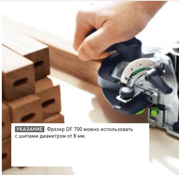
**УКАЗАНИЕ** Фрезер DF 700 можно использовать с шипами диаметром от 8 мм.
