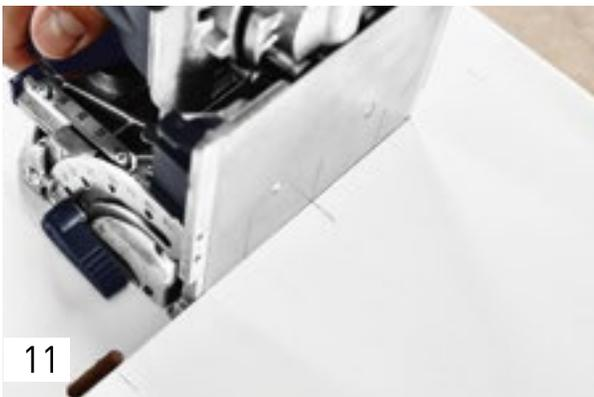
Для фрезерования остальных пазов настройте ширину продольного отверстия и отметьте место шипов на лежащей полке простой разметкой. Теперь установите дюбельный фрезер по разметке, используя метки на его нижней стороне (установите среднюю метку на отмеченной позиции).
