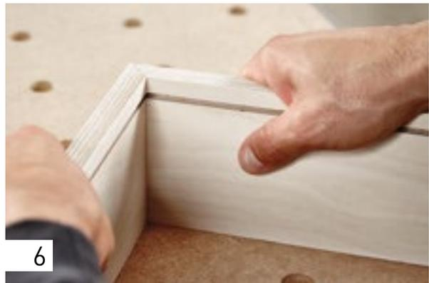
... и соедините части заготовки вместе.
