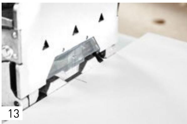
Последующие пазы изготовьте, используя шкалы смотровом окошке, выравнивая их по разметке. Изготовьте в кромке панели все пазы с узкой шириной – в них позднее, после нанесения клея, будут вставлены шипы с очень точной посадкой.
