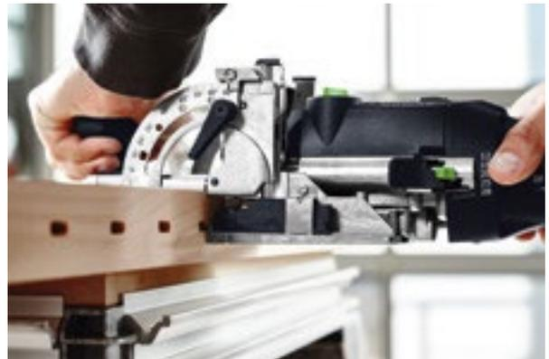
Отрегулируйте рабочую высоту фрезы по центру заготовки. Разметьте расстояние между стойками на верхней стороне заготовки. В этом случае (при работе с обычной разметкой) установите шкалу в смотровом окошке DOMINO поверх разметки и обработайте пазы. Двойная разметка, как в примере выше, здесь не потребуется.
