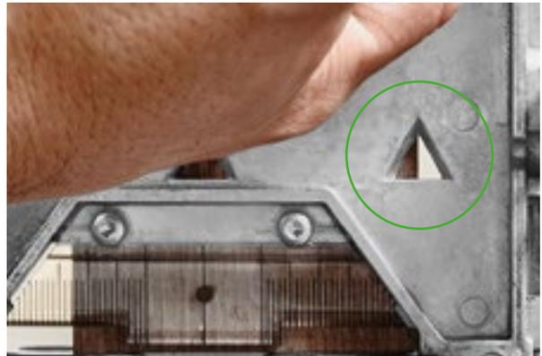
При этом верхний край заготовки виден в треугольном окошке фрезера. Если упорные элементы не требуются, они автоматически отжимаются во время фрезерования.
