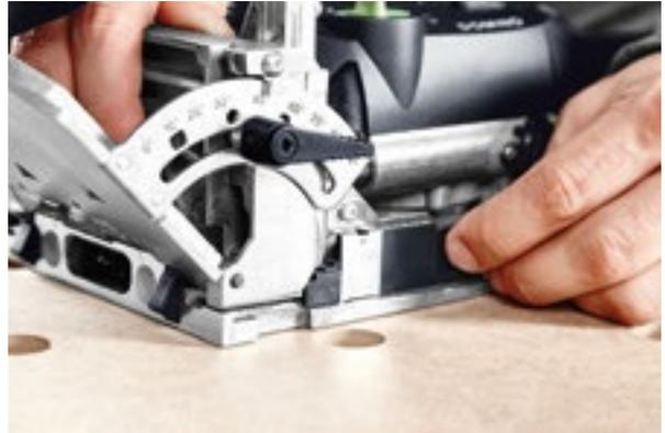
**СОВЕТ** Фрезеруйте тонкие заготовки под углом. Установите нужный угол. Расфиксируйте рычаг регулировки рабочей высоты фрезы, передвиньте ползунок до упора в направлении блока двигателя, после чего сдвиньте угловой упор полностью вниз. Зафиксируйте рычаг.
