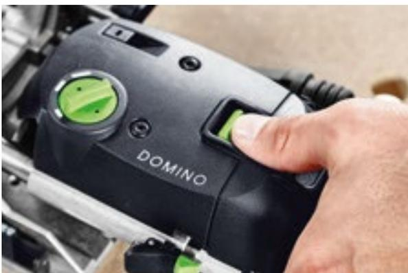
Для включения пазово-дюбельного фрезера DOMINO к нему нужно сначала подсоединить кабель plug-it и всасывающий шланг, а затем сдвинуть кнопку включения/выключения на верхней стороне инструмента вперёд и вниз до фиксации.
