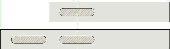
Упорные стержни позволяют выполнять фрезерование двух пазов на определённом расстоянии от опорной стороны рядом друг с другом (1 – 3).
