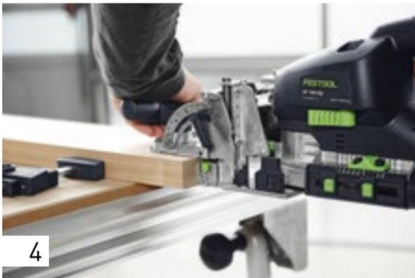
Установите глубину фрезерования 50 мм, чтобы обработать пазы в царге по разметке или с использованием системы упорных стержней (узкая ширина паза). Рабочая высота фрезы определяется по толщине заготовки. В приводимом примере толщина царги составляет 30 мм. Для центрирования паза в заготовке установите рабочую высоту фрезы на 15 мм.
