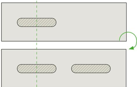
Упорные стержни обеспечивают фрезерование двух пазов под вставные шипы путём переворачивания заготовки, например при одинаковом сечении детали.
