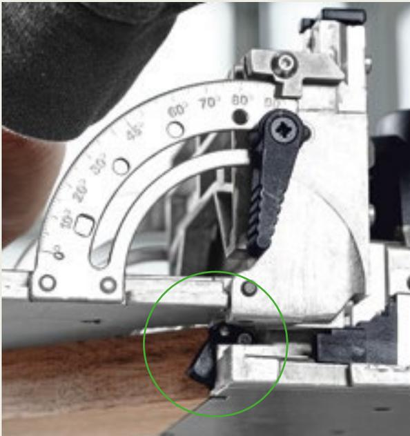
Проще всего определить позицию паза под шипы с помощью встроенных упорных элементов – это можно сделать быстро и точно для обеих заготовок. Расстояние между упорным элементом и центром инструмента составляет 37 мм. Установите DF 500 упорным элементом на край заготовки.
