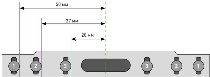
Упорные стержни выполняют функцию проставок относительно центра инструмента и могут использоваться по-разному:
