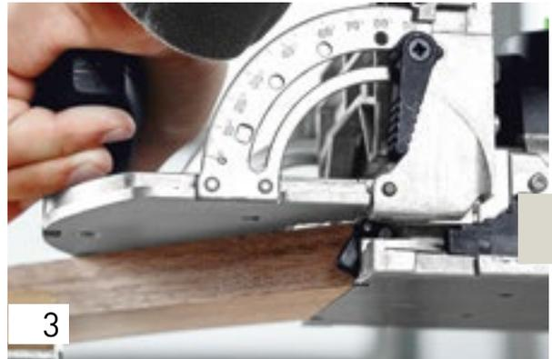
Для обеспечения максимальной прочности на каждое угловое соединение мы используем по два вставных шипа. Приставьте фрезер к обрабатываемой поверхности скоса и осторожно перемещайте его упорным элементом сбоку в направлении вершины скоса. Изготовьте первый паз точно по размеру шипа.
