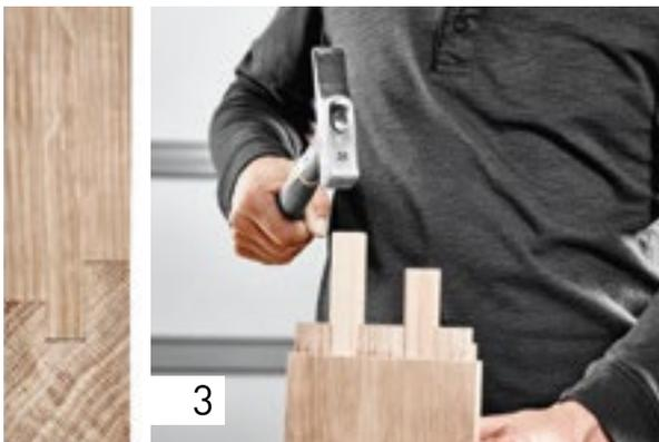
Теперь нарежьте шипы нужного размера из подходящего стержня для нарезания шипов. В представленном примере номинальная длина вставного шипа составляет 115 мм:  $2 \times \text{глубина фрезерования (70 мм)} = 140 \text{ мм}$  минус шиповое соединение 25 мм = 115 мм. Отрежьте шип на несколько миллиметров короче, чтобы потом осталось достаточно места для клея, – 112 мм. Снимите фаску на краях отрезанного шипа шлифком.
