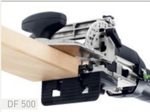
Дополнительный упор из комплекта DF 500 увеличивает опорную поверхность и уменьшает боковое расстояние между упорными элементами и центром DOMINO с 37 мм до 20 мм. Это обеспечивает очень точное позиционирование узких заготовок.
