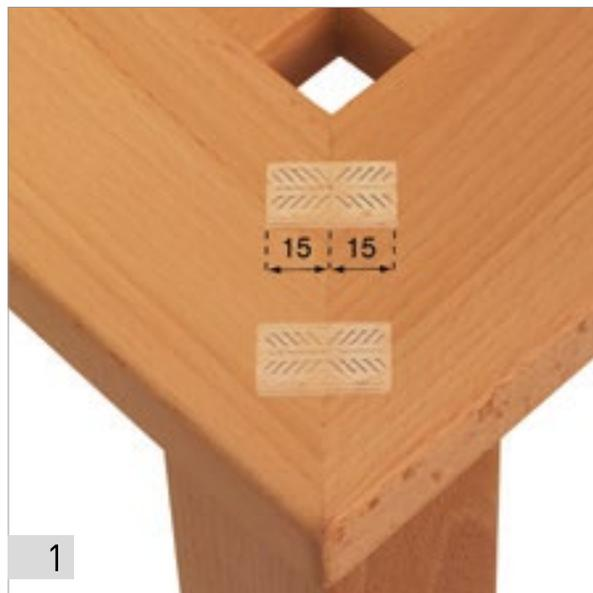
Здесь мы используем вставные шипы 5 x 30 мм. Поэтому установите глубину фрезерования на 15 мм.
