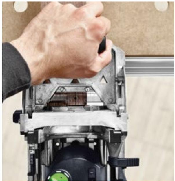
**DF 500:** разумеется, определить позицию паза под шипы DOMINO можно также путём простой разметки и установки фрезера по ней через смотровое окошко.
