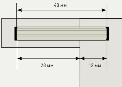
**СОВЕТ** В большинстве случаев вставной шип должен быть отцентрирован внутри соединения, т. е. глубина фрезерования должна соответствовать половине длине вставного шипа. Однако, в зависимости от заготовки или вида соединения шип можно установить не по центру. В этом случае общая глубина двух пазов в заготовках должна быть равна длине устанавливаемого шипа.
