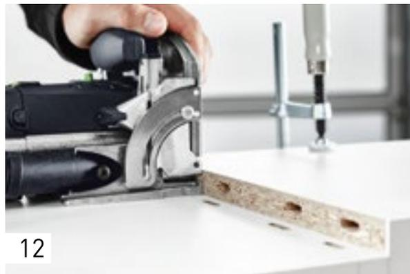
Теперь установите глубину фрезерования 25 мм и обработайте пазы под шипы в средней полке, опять используя упорный элемент для первого гнезда (с узкой шириной).
