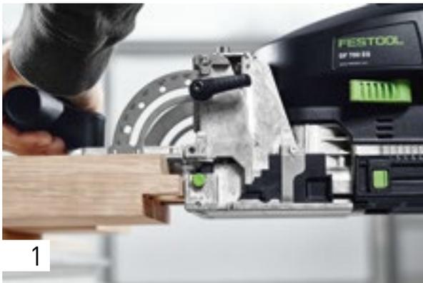
Разметьте места под шипы и работайте, используя смотровое окошко. Выполните в обеих заготовках пазы максимальной глубины 70 мм фрезой на 14 мм.
