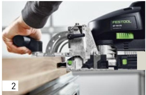
В вертикальном бруске обвязки также обработайте пазы глубиной 70 мм, но при этом первый паз выполните точно по размеру шипа, а второй – в виде продольного отверстия с зазором. Повторите эти операции с другими вертикальными и горизонтальными брусками обвязки.
