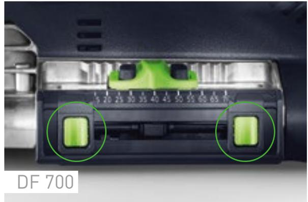
**СОВЕТ** С помощью двух зелёных маркеров можно отметить два значения глубины фрезерования и затем просто перемещать между ними ползунок. Это может помочь, например, при асимметричном распределении глубины установки шипа DOMINO, а также при серийной (одинаковой) глубине фрезерования.
