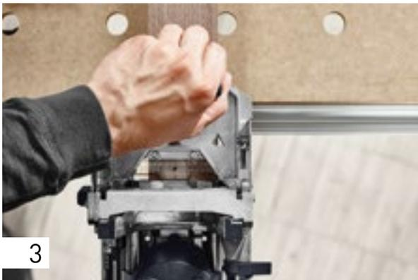
Второй шип выполнен с использованием упорного элемента – при этом способе можно позиционировать два шипа рядом друг с другом относительно опорной кромки.
