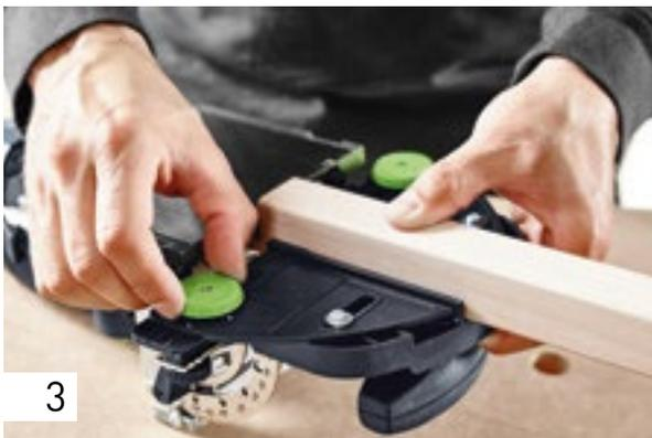
Проверьте с помощью планки, точно ли соответствует размер упора для планок, при необходимости отрегулируйте его повторно.
