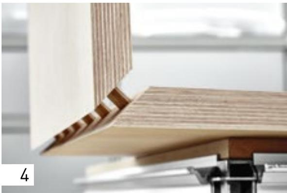
Затем соедините части заготовки вместе, тщательно смазав клеем вставные шипы.
