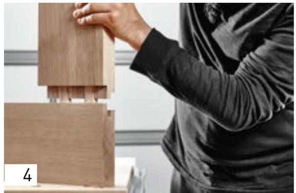
Затем забейте шипы до упора с добавлением клея в пазы в торце заготовки.
