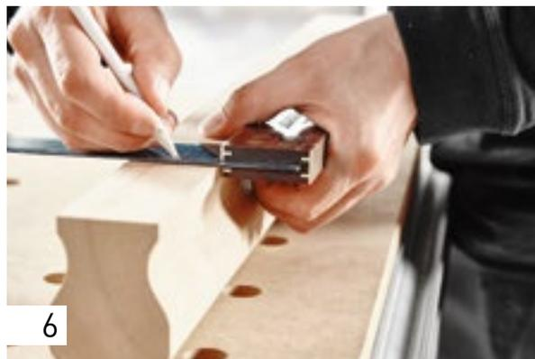
В этом случае также поможет упор для узких заготовок: разметьте места стоек на поручне там, где позднее будут пазы. На расстоянии 10 мм (при использовании DF 700 – 15 мм) от этой метки сделайте ещё одну метку, к которой позднее будет приставляться инструмент. Теперь установите угол фрезерования  $90^\circ$  – благодаря этому Вы сможете выполнять фрезерование в поручне в направлении вертикально сверху. Глубина фрезерования фрезой 6 x 40 мм составляет, как и для стоек, 20 мм.
