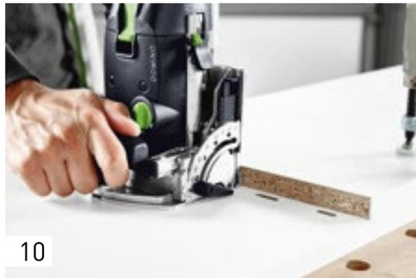
В нашем примере средняя полка и боковина расположены заподлицо и плотно зажимаются. Теперь установите угол дюбельного фрезера на  $0^\circ$ , а глубину фрезерования – на 15 мм. После этого обработайте первый паз под вставной шип с узкой шириной в лежащей боковине, используя упорный элемент.
