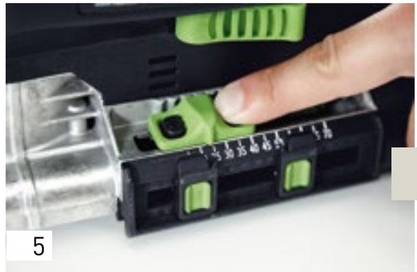
Теперь для обработки поперечного паза установите глубину 25 мм. (Этот размер зависит от конкретной заготовки – см. размерный чертеж; важно, чтобы поперечный паз перекрывал продольный на 3 мм по глубине).
