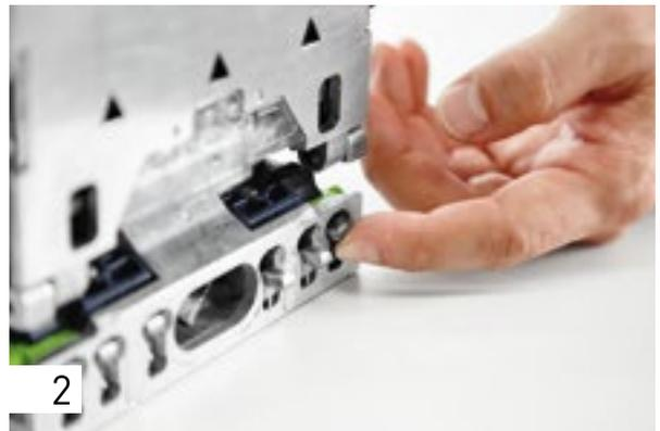
В этом случае рекомендуется работать с упорными стержнями. Выбирайте упорные стержни с учётом расстояния между пазами. Следите за тем, чтобы отверстие для углового соединителя располагалось не ближе, чем 37 мм от края заготовки. Если Вам необходимо работать с упорными стержнями, используйте, по крайней мере, средний упорный стержень.
