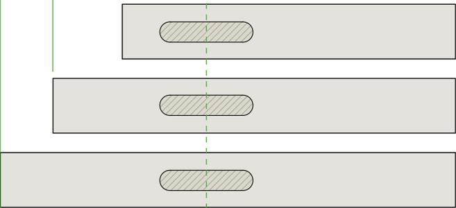
Упорные стержни (1 – 2 – 3) позволяют выполнять фрезерование на трёх различных расстояниях относительно опорной стороны.
