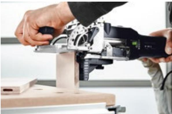
**УКАЗАНИЕ** Разумеется, соединения встык можно выполнить и на самых маленьких шипах DOMINO. Изготовьте пазы, как описано выше, под шипы с помощью дополнительного упора на торцевой стороне.
