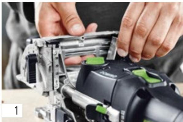
Отрегулируйте рабочую высоту фрезы под толщину заготовки, глубина фрезерования составляет половину длины вставного шипа. Фрезеруйте либо оба пазы точно по размеру шипа для максимальной высокой точности соединения, либо второй паз с зазором.
