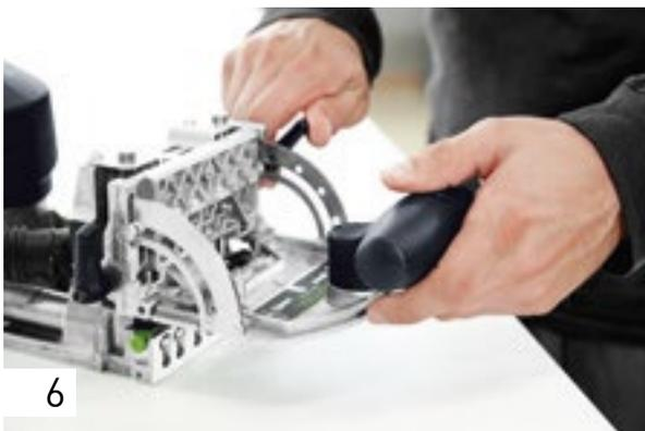
Рабочая высота фрезы, в любом случае, должна быть 40 мм. Такая высота обеспечит правильное расстояние поперечного паза от кромки заготовки и последующее закрепление анкерного болта в поперечной муфте.
