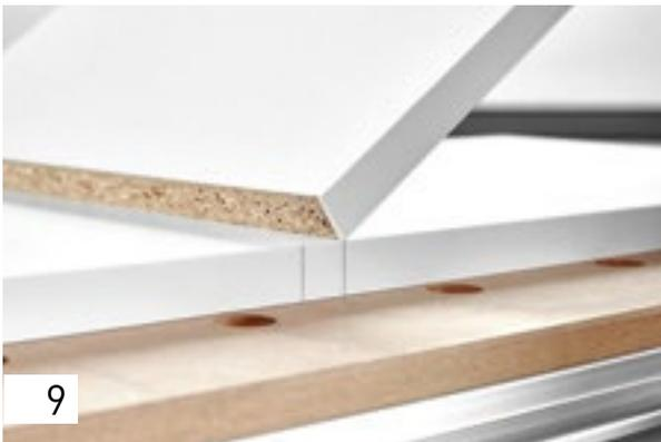
Отложите верхнюю боковину в сторону. Установите среднюю полку по разметке и наклоните её вправо или влево так, чтобы верхняя или нижняя кромка полки была выровнена относительно нанесенной метки. Плотно зажмите обе детали (средняя полка и боковина).
