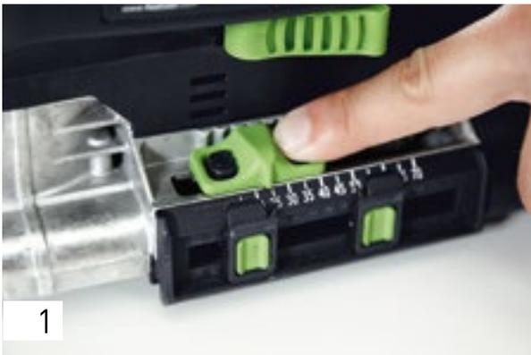
Установите глубину фрезерования на дюбельном фрезере на 25 мм, маркеры – на 25 мм и 50 мм.
