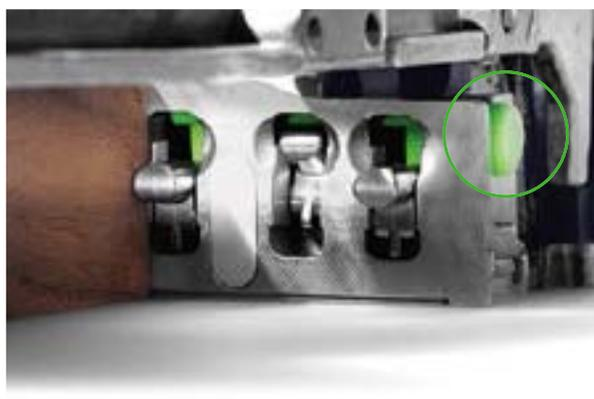
На стороне упоров пазово-дюбельного фрезера расположено шесть упорных стержней. Не используемые упорные шипы можно зафиксировать по отдельности путём отжатия или расфиксировать их сразу все вместе нажатием кнопки, расположенной сбоку на фрезере (см. изображение).
