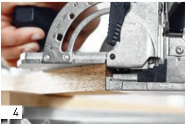
Для изготовления второго паза либо разметьте его положение, либо выровняйте край основания фрезера по вершине скоса. Этот паз можно выфрезеровать точно такого же размера, что и первый – это повышает прочность соединения, но вместе с тем требует большей точности работы. Или изготовьте второй паз с зазором, но в этом случае Вам придётся использовать для соединения достаточное количество клея.
