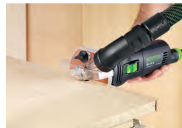
Фрезерование пластмассовой или деревянной кромки заподлицо.
