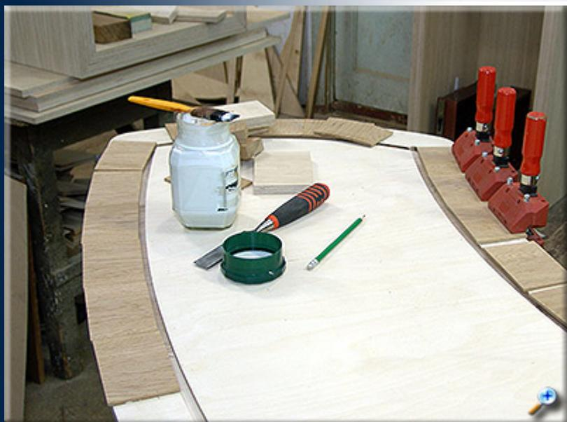
Поле от кромки до паза выклеиваем дубовыми ламелями толщиной 6-7мм. Направление волокон поперек.
