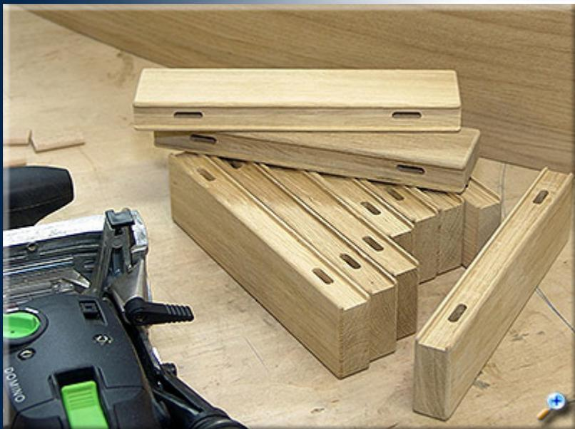
Дубовые бруски со стороны крепления к панелям имеют неглубокий паз, изготовленный при помощи стационарно закрепленного фрезера и пазовой фрезы. Паз скроет стык между деталями при склейке.
