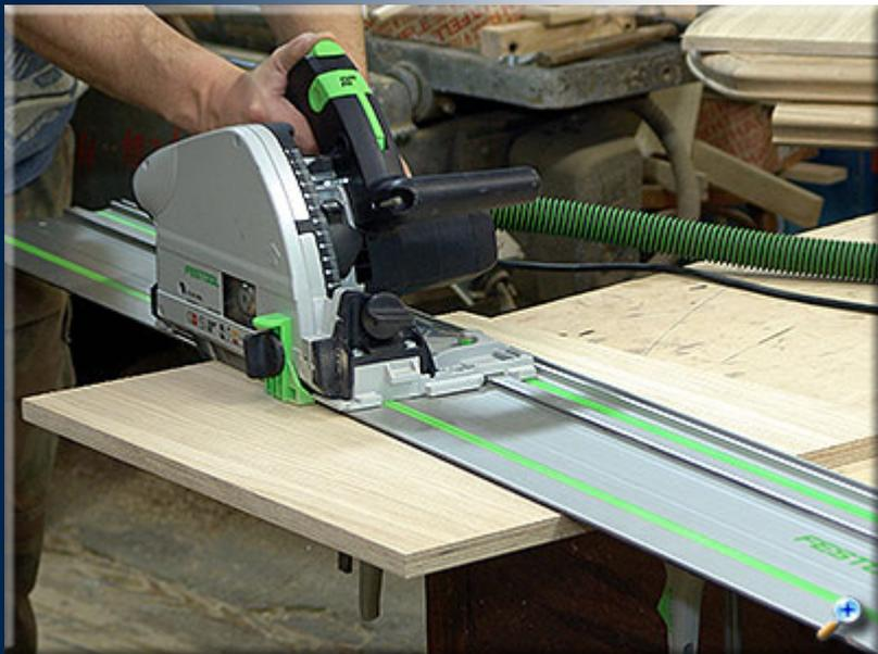
В большинстве ячеек столешницы будут находиться стекла, но часть будет иметь панели из фанеры. Вырезаем фрагмент по форме ячейки при помощи погружной пилы.
