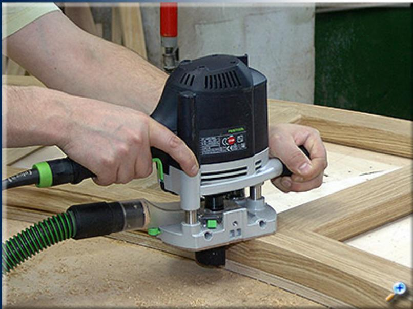
Обрабатываем кромку профильными фрезами с необходимым рисунком.
