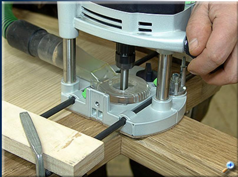
Трубы пройдут сквозь столешницу. Для этого необходимо сделать строго вертикально сквозные отверстия. Как и в случае с карнизом, используем ручной фрезер, но чтобы исключить смещение фрезера во время сверления, фиксируем его при помощи струбцин и штанг от бокового упора.
