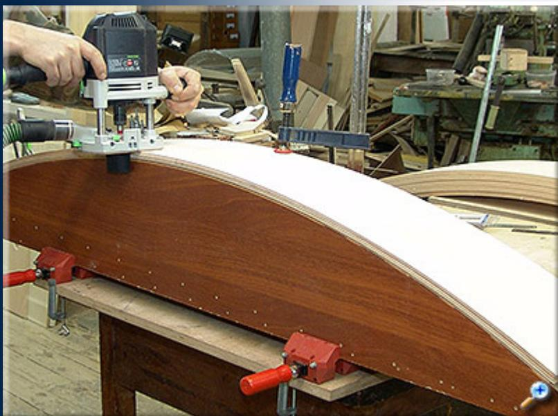
Фанерные заготовки с небольшим запасом по габаритам клеятся между собой на радиусной матрице в несколько слоев. После высыхания деталь сохраняет изогнутую форму. Далее панель фрезеруется по ширине в необходимый размер прямо на матрице для склеивания. Для этого использовалась обгоночная фреза с опорным подшипником и ручной фрезер.
