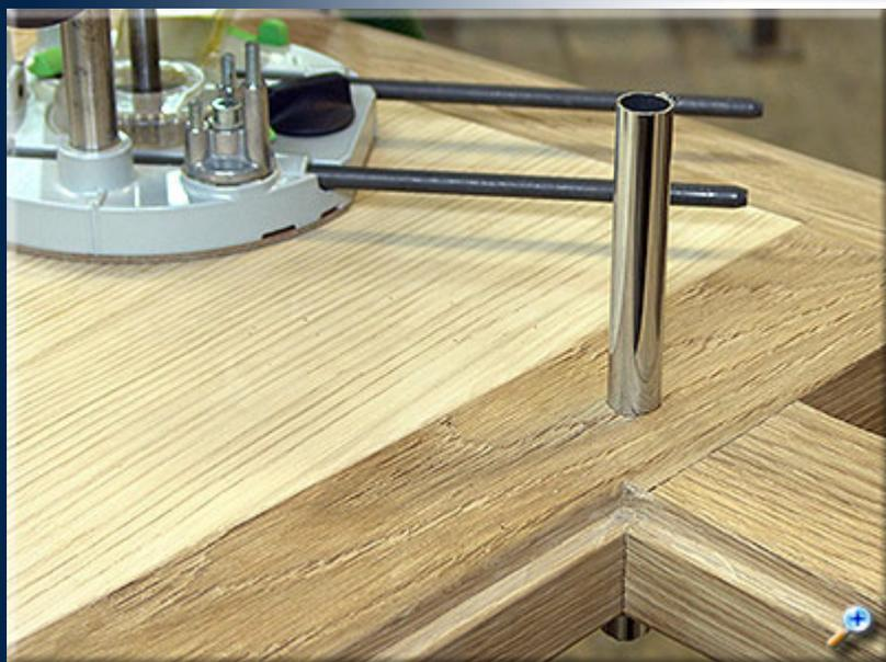
Снизу, для предотвращения сколов, желательно закрепить небольшой фрагмент древесины или фанеры. Если отверстие просверлено без смещения, то труба беспрепятственно пройдет сквозь столешницу.
