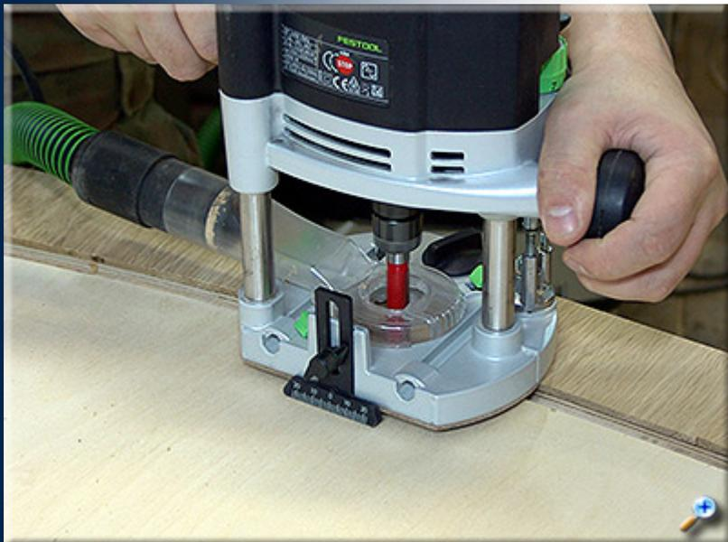
Теперь выровняем наклеенные ламели по краю паза. Опорный подшипник обгоночной фрезы передвигается внутри паза. Чтобы не заваливать фрезер, устанавливаем боковую опору.
