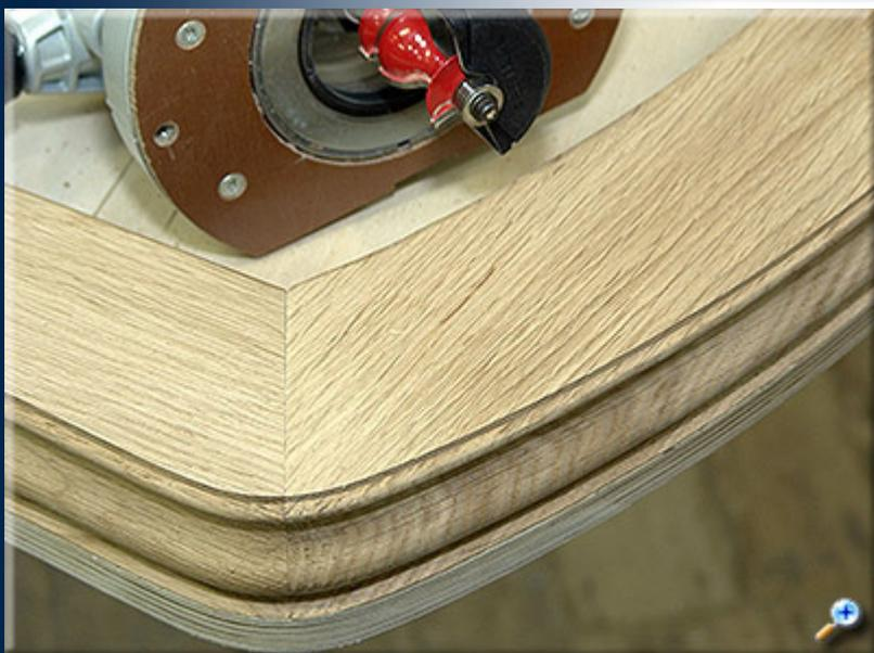
Так, как на первом этапе обработки базой для подшипника служит фанерный шаблон, то плавность линий и качество самого шаблона отразится на поверхности кромки.
