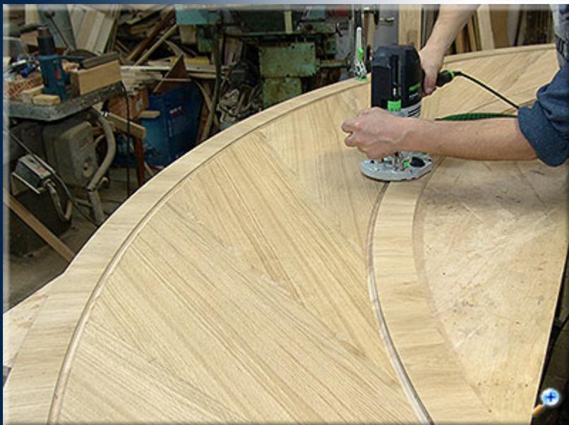
Выступающие края шпона повторно фрезеруем обгоночной фрезой. Основная идея заключается в том, что через отверстия в глубине паза карниз крепится к потолку. Точки крепления будут скрыты декоративным штапиком, вклеенным в паз карниза.
