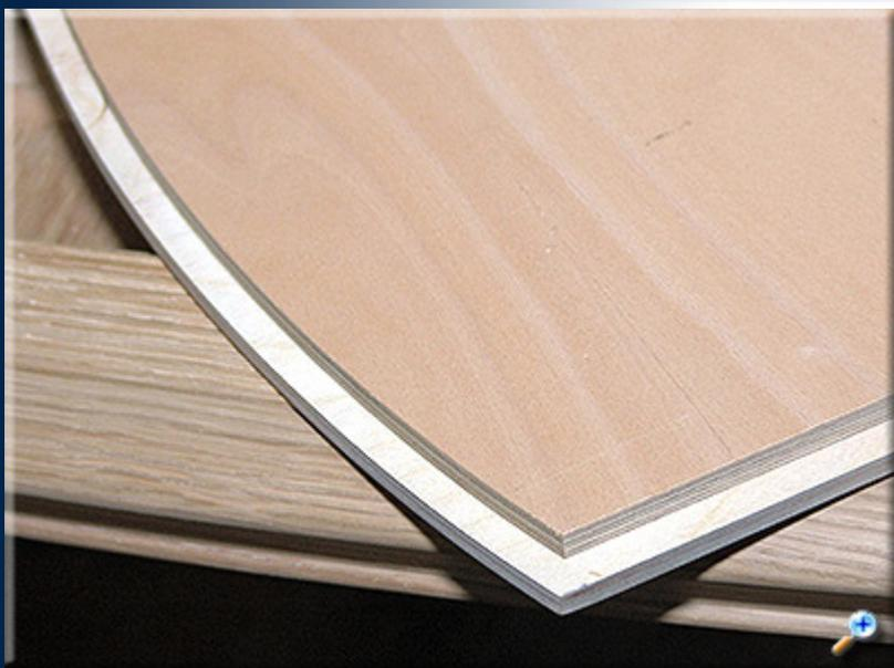
Ручным фрезером отбираем четверть по периметру панели.
