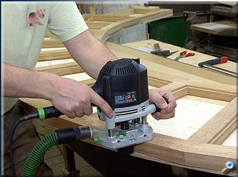
После высыхания клея, фиксируем столешницу на шаблоне и обрабатываем кромку фрезером с обгоночной фрезой.
