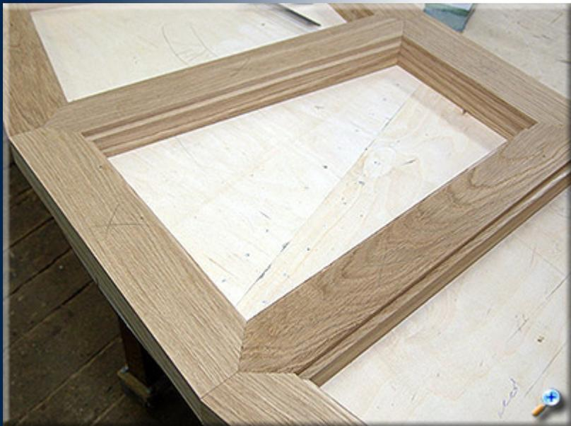
Столешница будет иметь стеклянные вставки, для которых в брусках при помощи стационарно закрепленного фрезера отбираются четверти.
