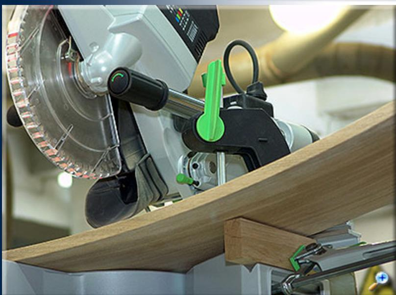
Так, как деталь имеет изогнутую форму, приподнимаем один край на необходимую высоту при помощи бруска, закрепленного струбциной к корпусу торцовочной пилы.
