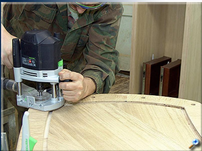
В конструкции барной стойки предусмотрены хромированные трубы, проходящие через столешницу от пола до потолка. В местах входа труб в карниз делаем углубления. В данном случае фрезер выполняет роль сверлильного станка.
