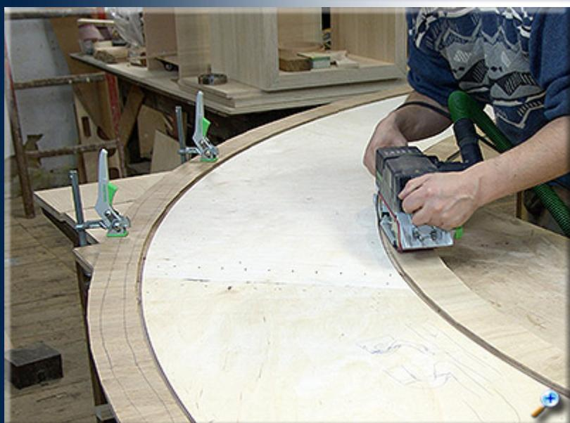
Удаляем выступивший клей и шлифуем плоскость ленточной шлифмашиной.
