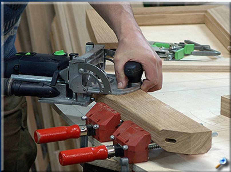
Все детали столешницы соединяются между собой при помощи вставных шипов «Domino». Для этого в торцах заготовок фрезеруем пазы дюбельным фрезером DF 500.
