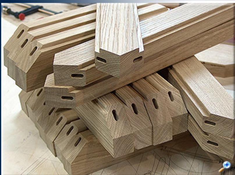
Поперечные детали имеют по два паза на скошенных гранях торцов.
