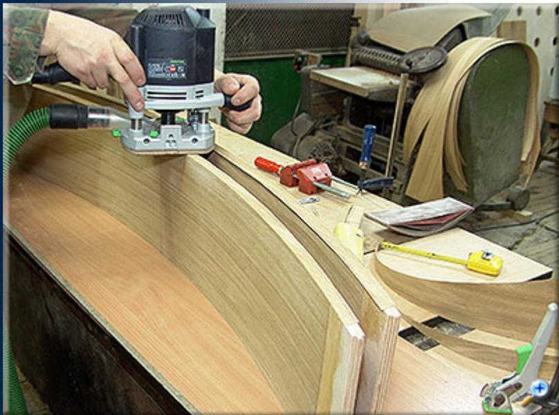
Кромки панелей так же фанеровались дубовым шпоном. Чтобы фрезер не заваливался, обработка кромок производилась на попарно установленных деталях.
