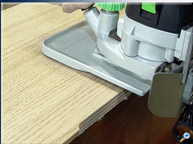
Затем тыльная и лицевая поверхности гнутых панелей фанеровались дубовым шпоном. Выступающие края шпона фрезеровались кромочным фрезером OFK 700 с использованием контактной пластины (сглаживает неровности при обработке кромки).
