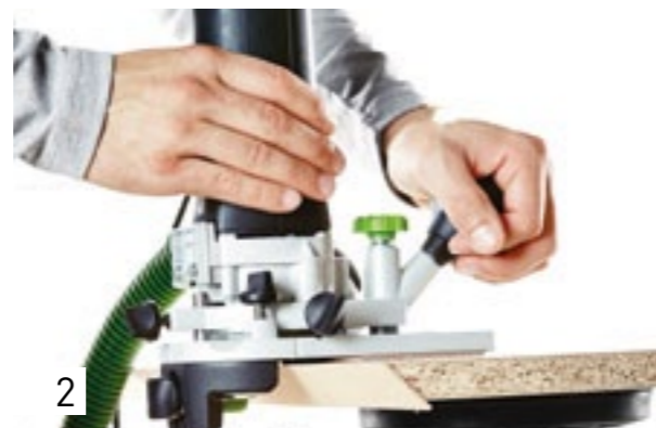
2 Затем выполните фрезерование заготовки заподлицо.
