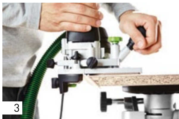
3 Следите за тем, чтобы кожух для удаления пыли прилегал снизу непосредственно к заготовке: так он может использоваться в качестве направляющей. Затем с помощью шлифовального материала обработайте радиус на кромке.
