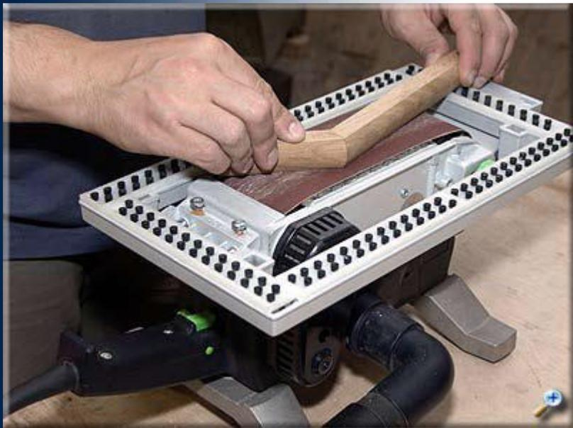
Возможные незначительные перепады и остатки выступившего клея шлифуем на ленточной шлифмашинке. Для удобства и предотвращения заваливания детали при шлифовке стыка, можно использовать шлифовальную рамку.
