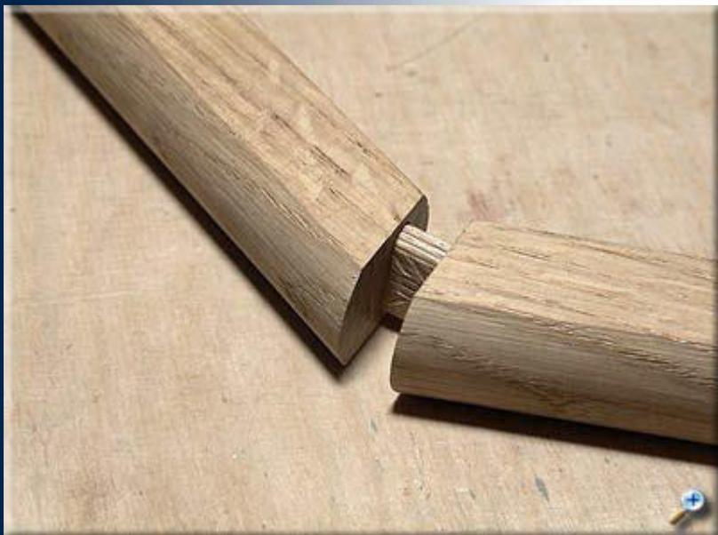
Возвращаемся к тестовой детали и пробуем собрать соединение пока без клея.
