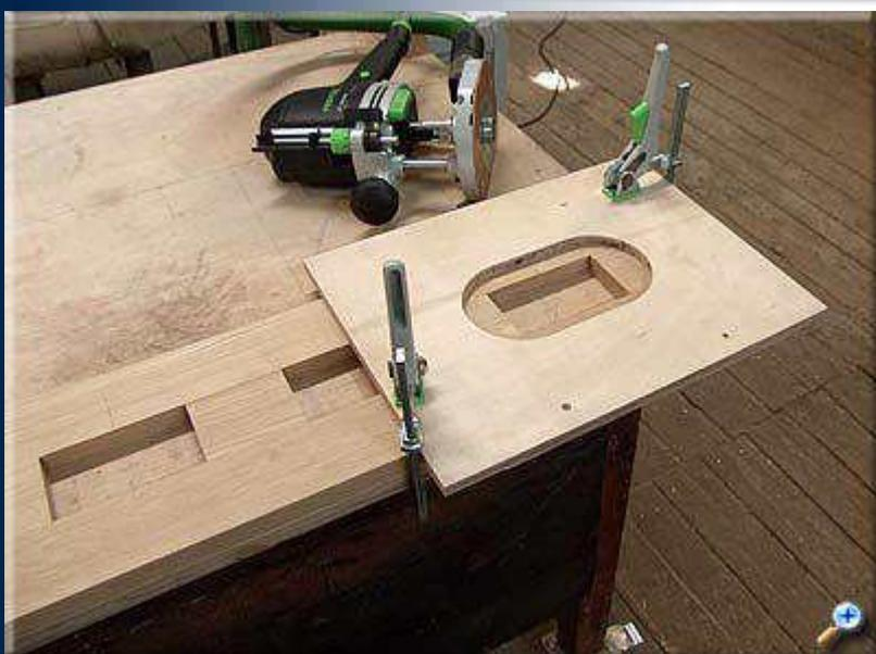
Используя несложный шаблон из фанеры, можно придать отверстию необходимую форму. Для удобства на шаблоне снизу прикреплен брусок (заметны шурупы на фото), который служит базовым упором при переустановке шаблона на новое отверстие.
