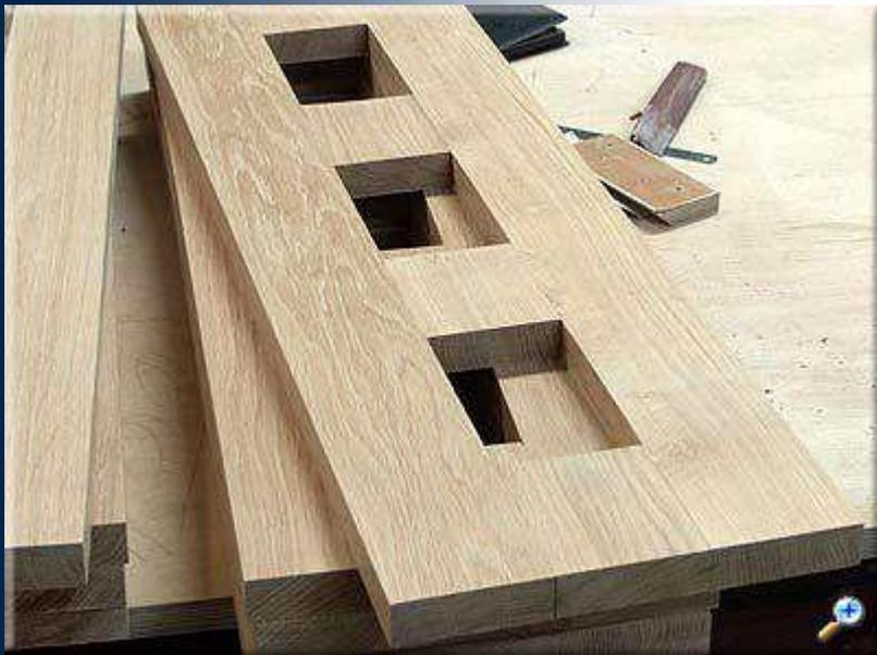
Следующий этап - изготовление боковых стенок. Для экономии материала, склеиваем боковины из фрагментов, как показано на фотографии.
