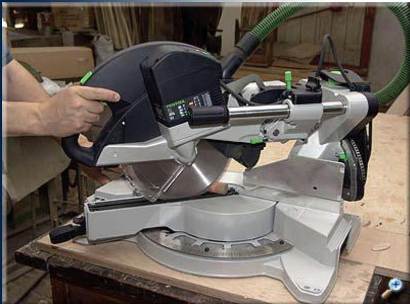
На подготовленных брусках со скругленными сторонами (прутья решетки), срезаем край под углом 45°.
