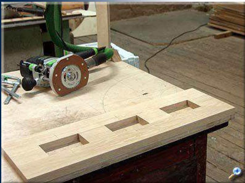
Для обработки отверстий в боковинах понадобится ручной фрезер с копировальным кольцом. Предварительно размечаем середину отверстия для дальнейшего совмещения с шаблоном.
