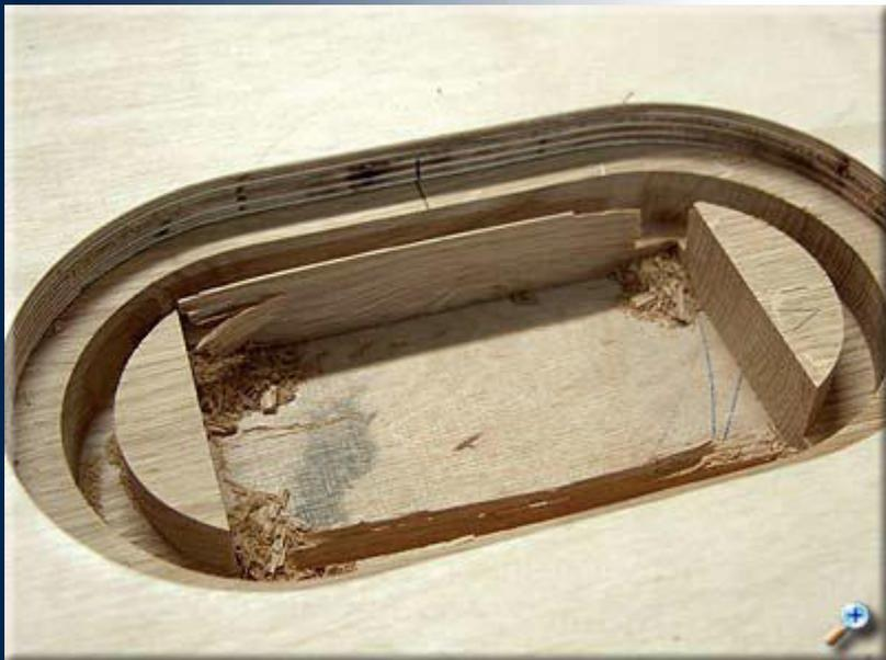
Дорезать отверстие можно лобзиком с небольшим отступом. На данном этапе особой точности не требуется, так как зона резанья лобзика удаляется при следующей операции.
