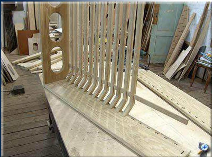
Предварительно собираем детали в единую конструкцию.
