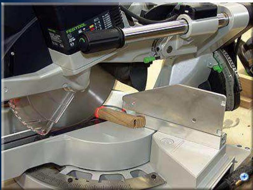
Так как прутья решетки состоят из двух частей, то обрезав необходимую длину нашего бруска (с пазом на торце), получим верхнюю часть. Рез производим под углом  $22,5^\circ$
