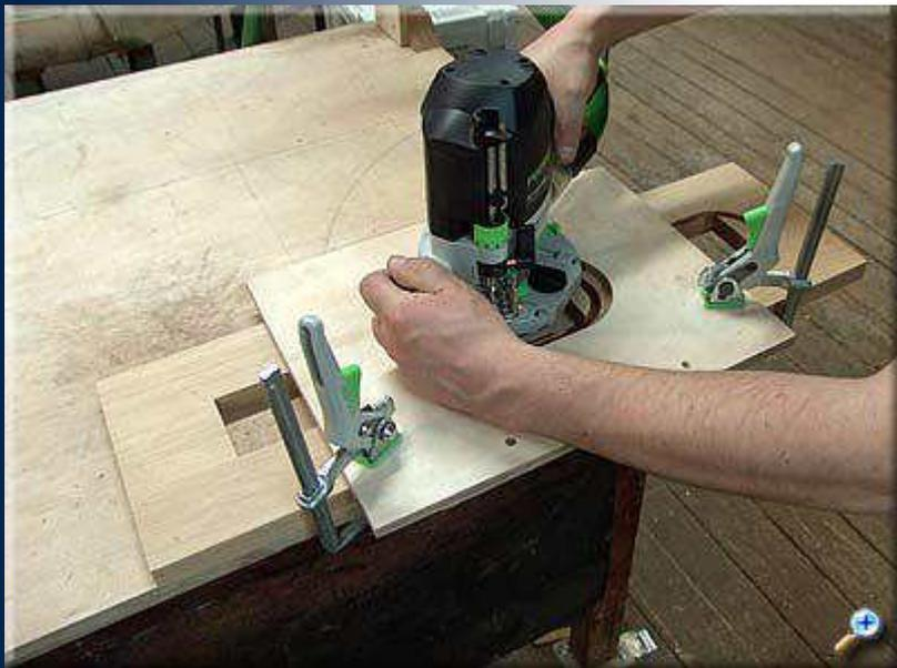
Поочередно фрезеруем отверстия, передвигая по меткам фанерный шаблон и фиксируя его струбцинами.
