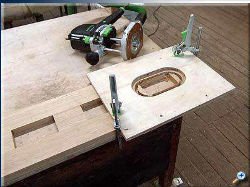
Фрезеровать "на вылет" нет необходимости, так как освободившиеся куски могут попасть между обрабатываемой поверхностью и фрезой, повредив при этом либо деталь, либо отбросив фрезер в сторону, что также может повредить изделие.
