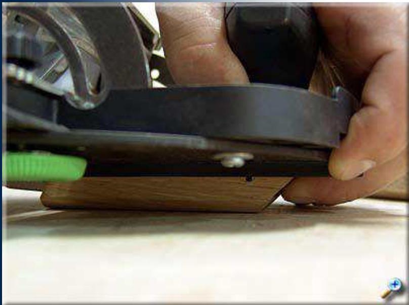
Сбалансированная работа фрезера позволяет удерживать заготовку одним пальцем. Но для гарантированного качества и в целях безопасности, рекомендую заготовку фиксировать.
