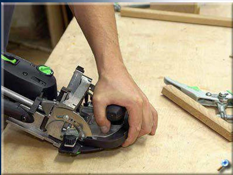
Снова, используя фрезер «Domino», делаем паз под шиповое соединение на торцах со скосом  $22,5^\circ$  (отрезанной и оставшейся части бруска).
