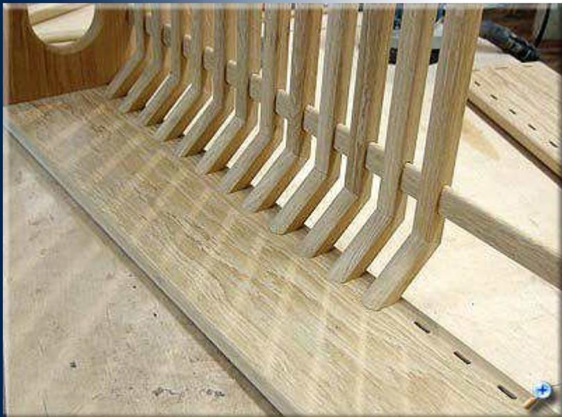
Используя фрезер «Domino», фрезеруем с заданным шагом пазы в крышке решетки.
