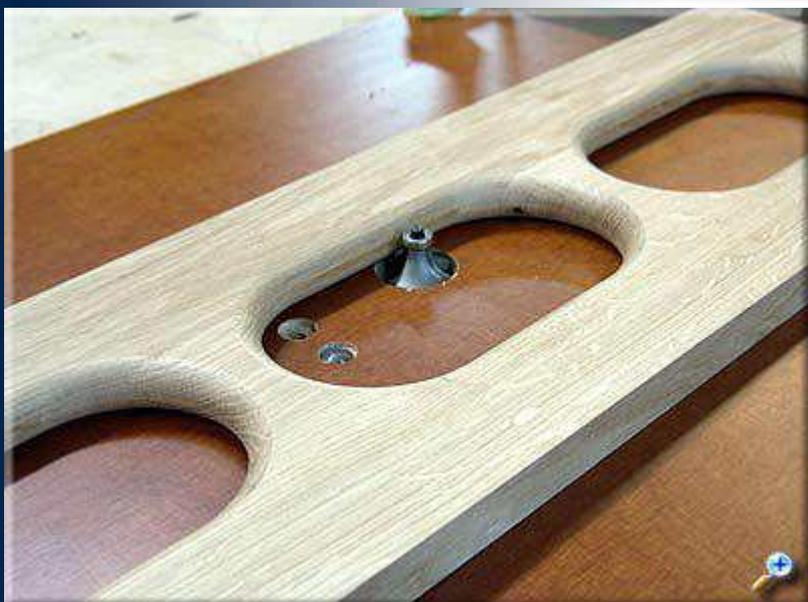
Устанавливаем фрезер в стационарное положение и обрабатываем с обеих сторон кромки отверстий.
