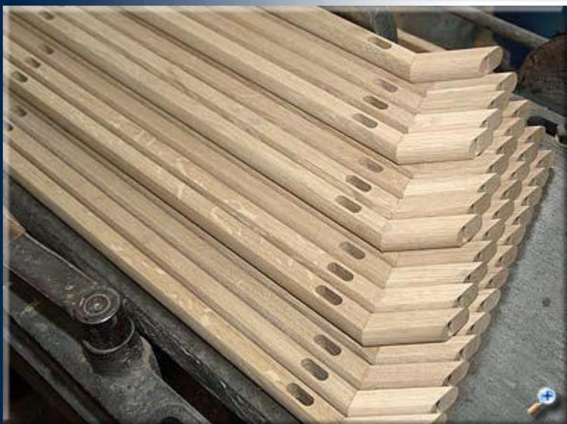
Так как "прутья" решетки будут нанизываться на рейки, делаем сквозные пазы. Для этого используем фрезер «Domino», только меняем фрезу на большую  $\varnothing 10\text{мм}$ .
