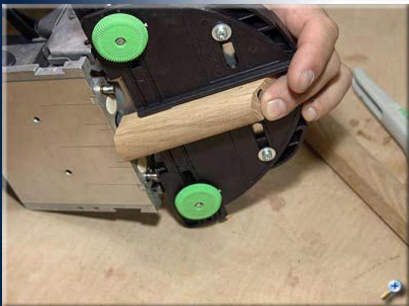
Специальный упор для планок позволяет надежно базировать узкую заготовку при фрезеровании паза в торце, в том числе под углом.
