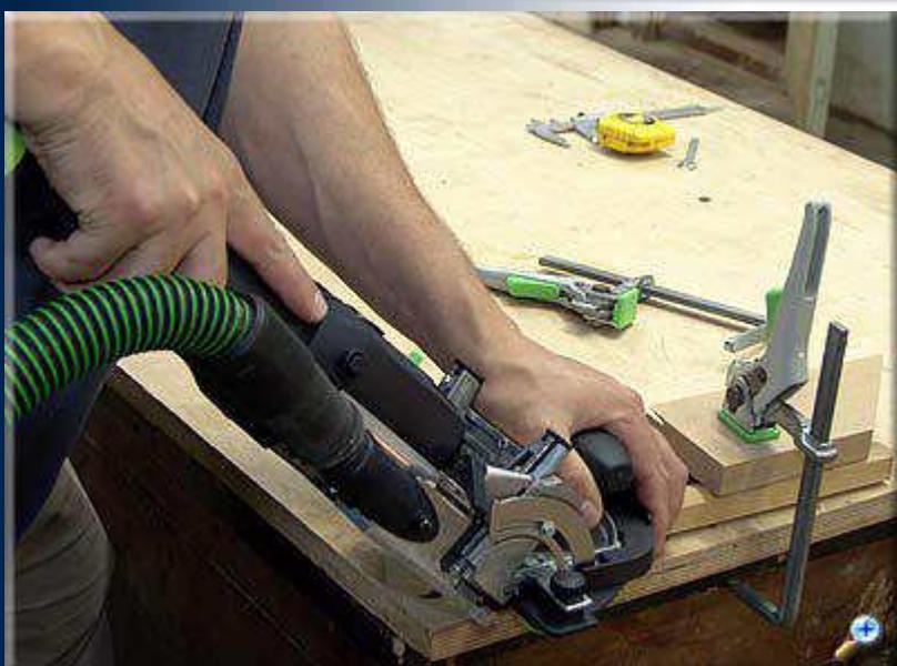
В скошенном торце заготовки делаем паз для шипового соединения, при помощи дюбельного фрезера «Domino».
