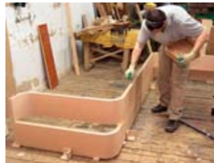
9 Vormontage der Treppe in der Werkstatt mithilfe eines Laserprojektors
