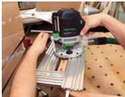
8 Fräsen der Tropfnuten für den bei der Montage austretenden Holzleim
