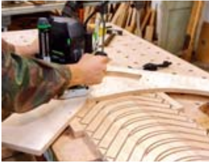
1 Stück für Stück: Ausfräsen unzähliger Segmentbögen aus einer Buchensperrholzplatte
