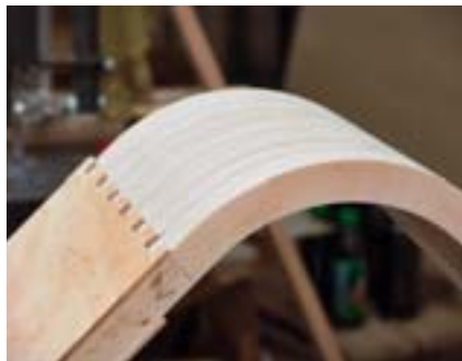
5 Die Zinken sorgen für saubere Längsstöße und erlauben ein Beplanken in Etappen
