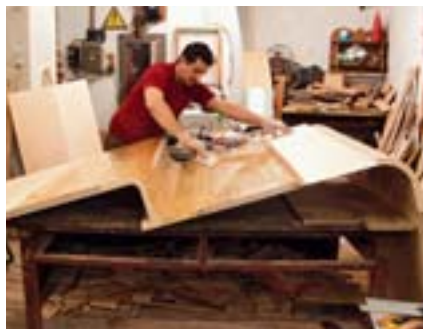
11 Beleimen des Treppenpodestes vor dem Aufbringen des Buchendeckfurniers
