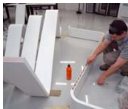
18 Leim und Domino-Dübel halten die einzelnen Elemente später sicher zusammen
