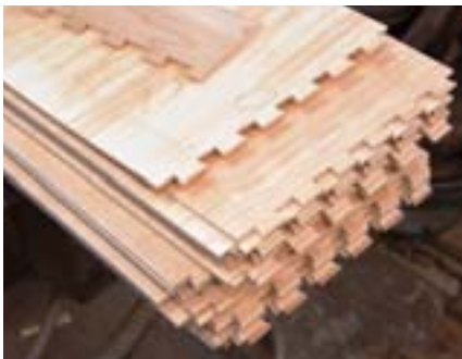
4 Ahornsperrholz mit Schwalbenschwanzzinken für die Längsbeplankung der Stufenelemente
