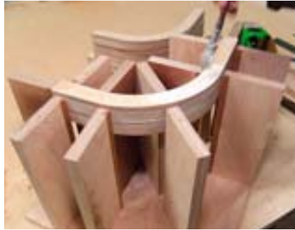
2 Blockverleimen der Segmentbögen in einer Vorrichtung – das spart spätere Nacharbeit
