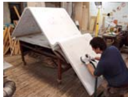
12 Lackzwischen Schliff am Podest mit dem Exzenterschleifer
