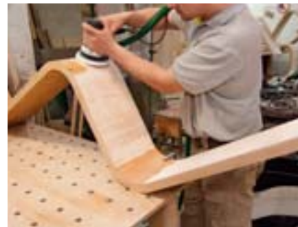
6 Vor dem Furnieren erhält die Fläche noch einen Schliff mit dem Exzenterschleifer
