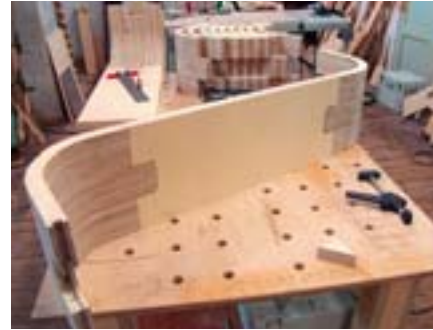
3 Treppenstufe mit zwei Viertelkreissegmenten, verbunden mit gespundeten Fingerzinken
