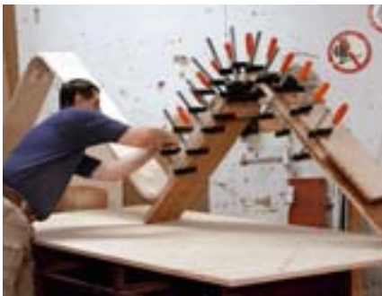
7 Etappe für Etappe: Aufbringen des Buchendeckfurniers mit Schraubzwingen und Zulagen
