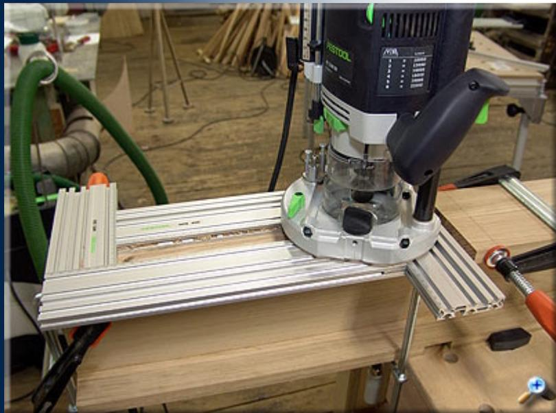
Углы нижней панельной части пилястры оформляем скругленной фаской. Для этого снова скрепляем детали попарно и при помощи MFS шаблона фрезеруем фаску необходимой длины.
