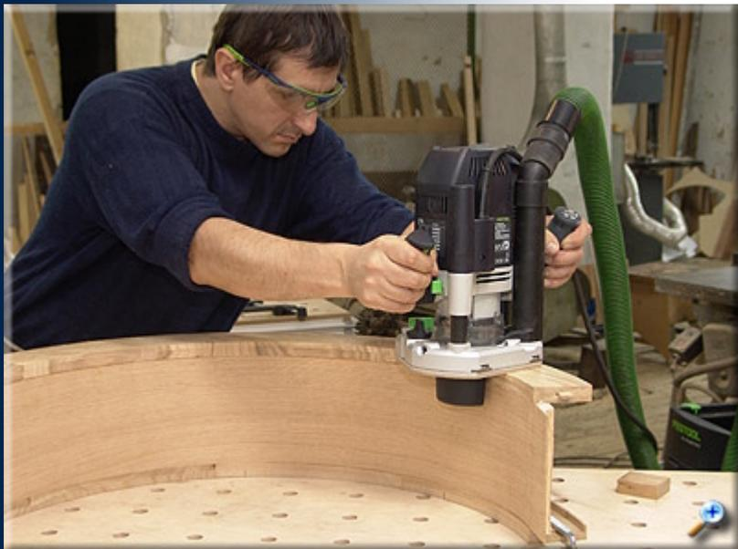
После того, как клей высох можно обработать внутреннюю кромку. Базой для подшипника служит поверхность свода и соответственно архивольт идеально повторит его форму.
