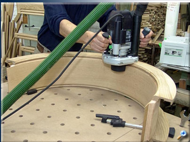
Профильной фрезой наносим рисунок на кромку архивольта с внутренней стороны.
