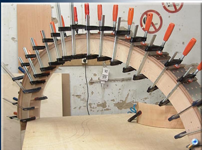
Форма готова. Так же, как и в первом случае, наносим клей, фиксируем заготовку струбцинами и оставляем до полного высыхания.
