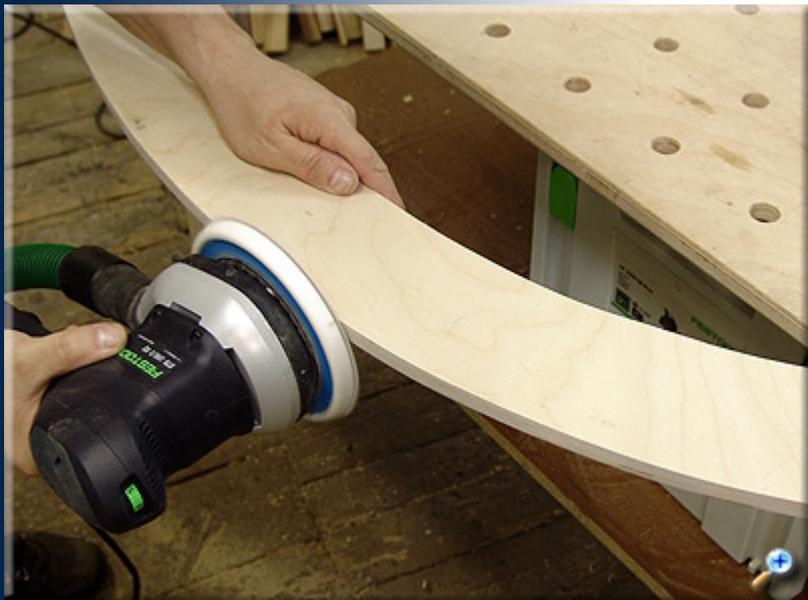
Когда все фрагменты склеены и обрезаны лобзиком, небольшие неровности кромки можно обработать эксцентриковой шлифмашинкой. Для достижения хорошего результата необходимо применять твердую шлифовальную тарелку
