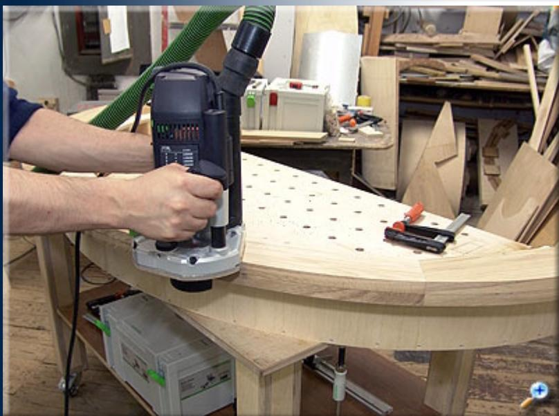
Не снимая первую деталь, прикладываем к ней следующую заготовку, отмечаем карандашом линию кромки и обрезаем лобзиком с небольшим припуском. Затем, используя первую деталь как копир, обрабатываем вторую заготовку.
