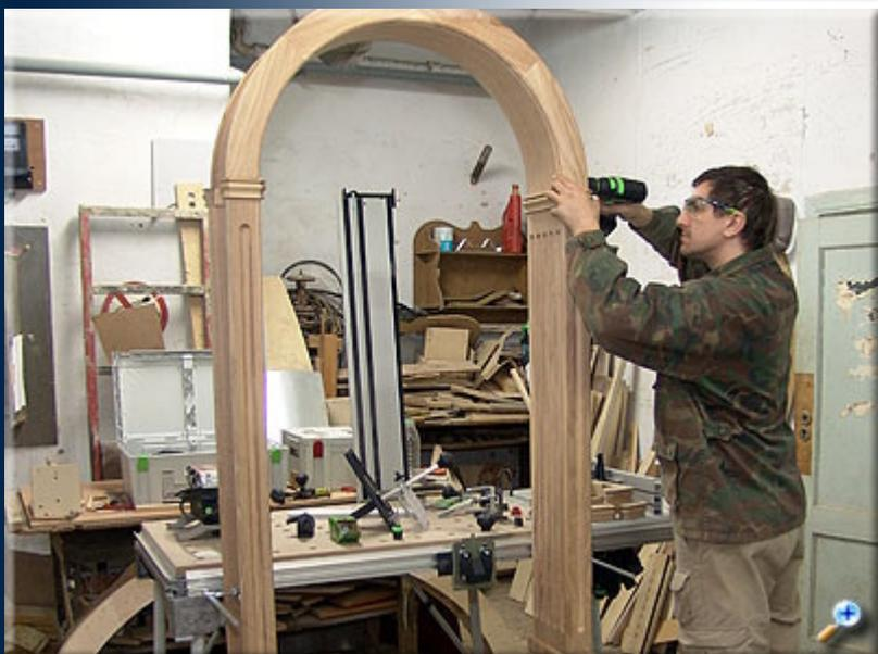
Предварительно закрепив пилястры на необходимом расстоянии к столу MFT, устанавливаем верхнюю часть арки.
