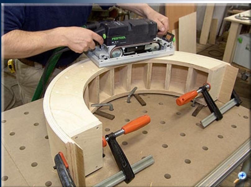
Шлифуем кромку ленточной шлифмашинкой. Вынимаем из под формы пластины, переворачиваем заготовку и так же обрабатываем кромку с противоположной стороны.
