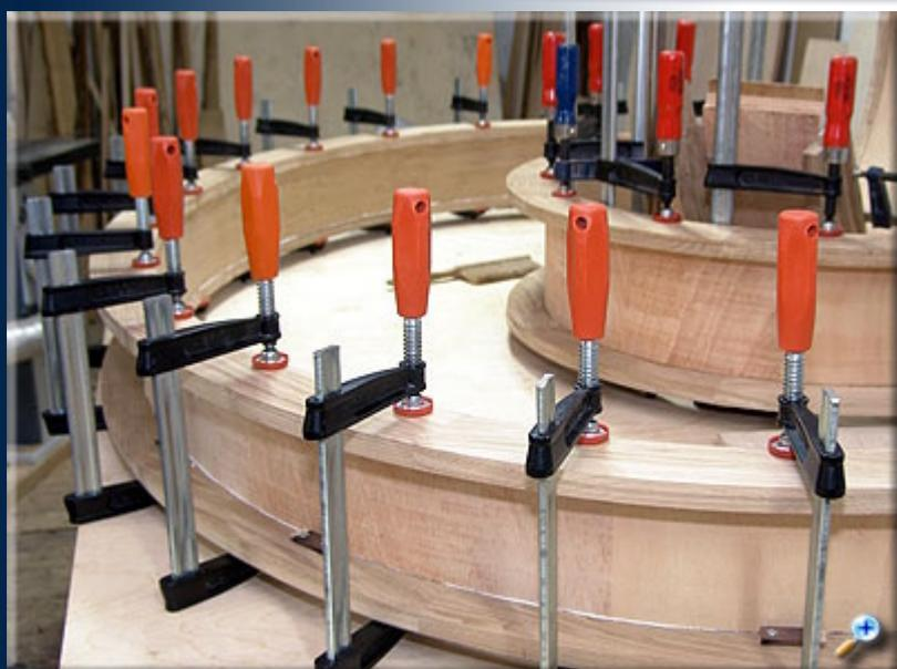
Клей нанесен. Детали зафиксированы. Ждем высыхания.
