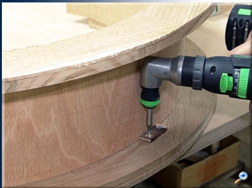
Перед склеиванием верхних частей арок необходимо сделать подготовительные работы, обрезать с припуском внутренние стороны обрамляющих дуг (архивольта) и установить небольшие упоры. Они не допустят смещение деталей относительно друг друга в процессе склеивания.
