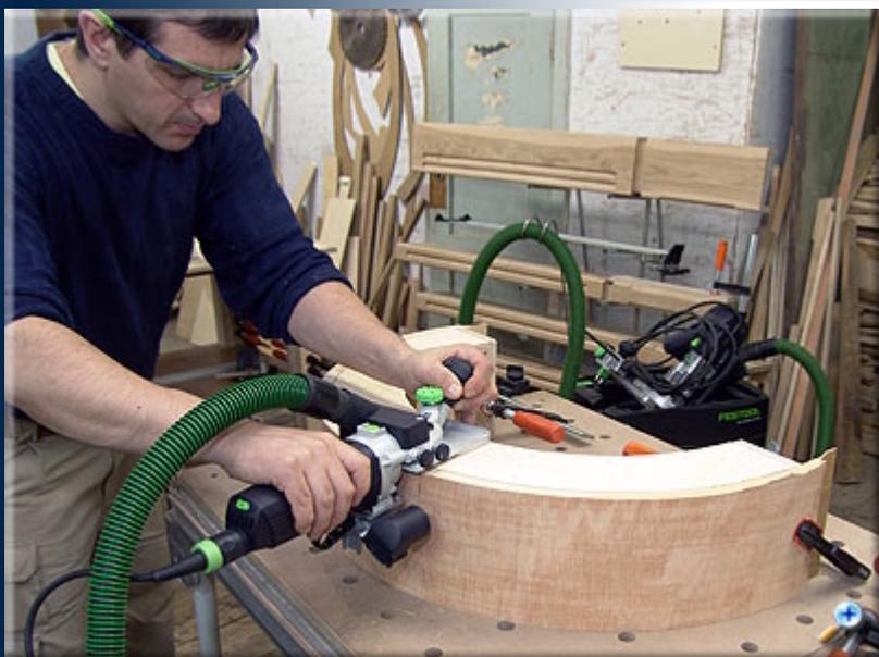
Используя кромочный фрезер с пластиной 0° градусов, срезаем кромку до плоскости формы.
