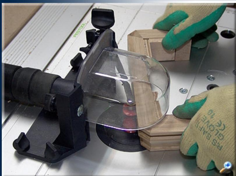
Капитель обрабатываем на фрезерном столе профильной фрезой с опорным подшипником.
