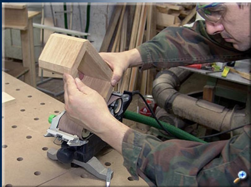
Остатки высохшего клея удаляем на ленточной шлифмашинке, закрепленной стационарно.
