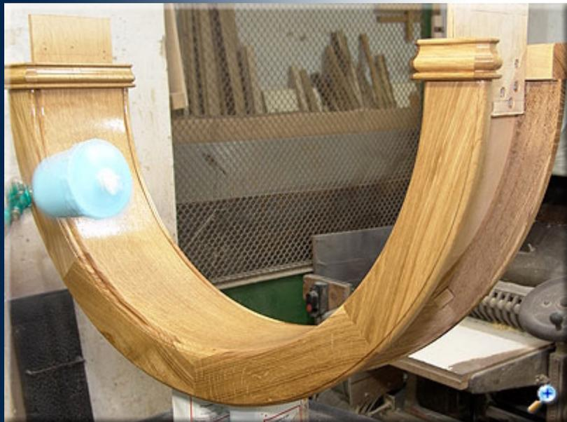
Снова разбираем арки на фрагменты и наносим лаковое покрытие. Технологии нанесения могут отличаться в зависимости от задачи и применяемых материалов.
