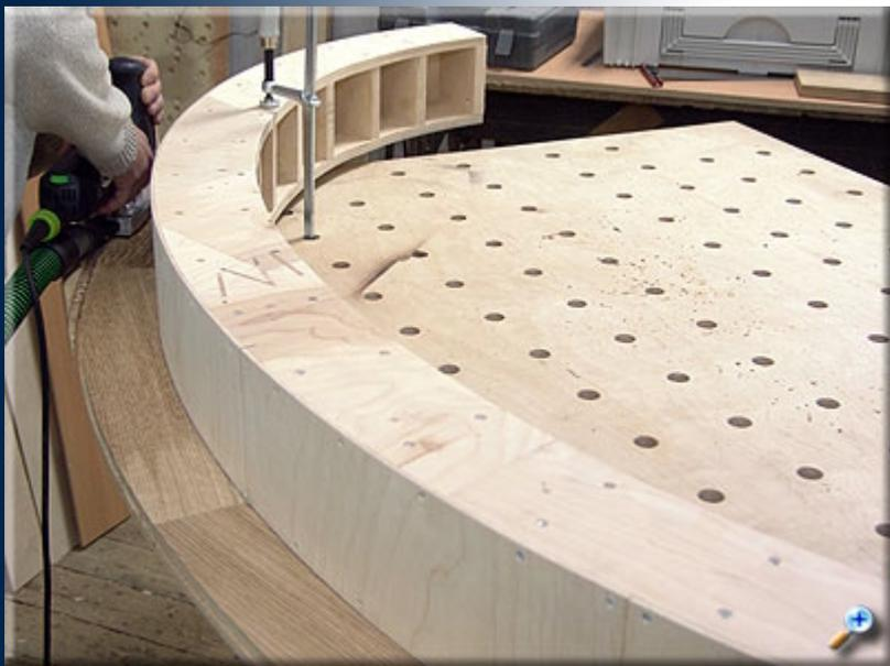
Срезаем лобзиком лишние фрагменты, переворачиваем деталь вместе с формой и дорабатываем внешнюю кромку пригоночной фрезой с опорным подшипником.
