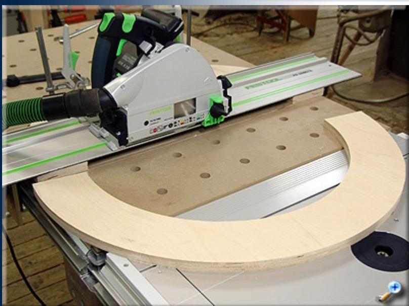
При помощи погружной пилы разрезаем кольцо на две равные части.
