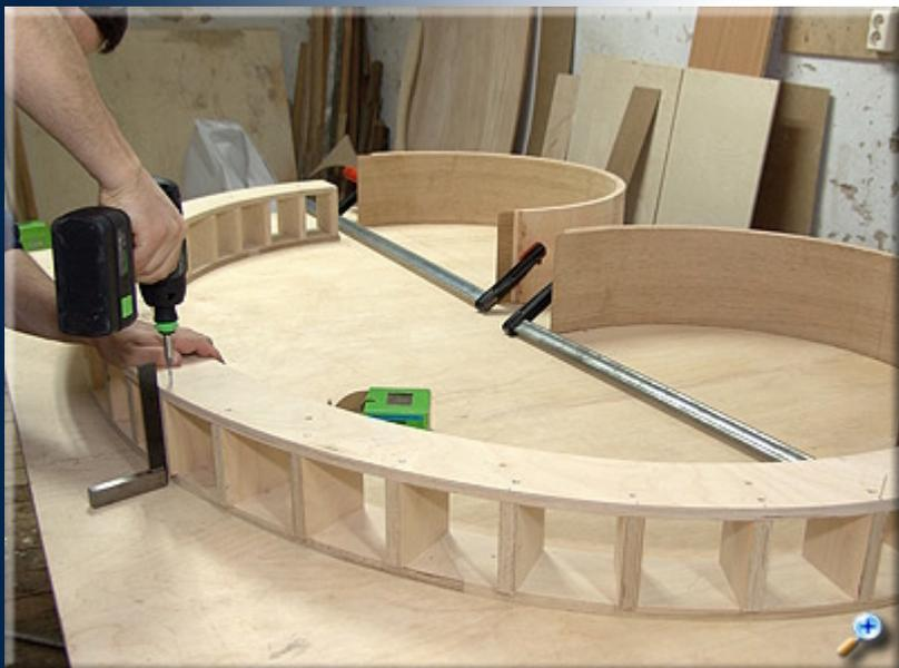
Используя перемычки, скручиваем подготовленные детали между собой.
