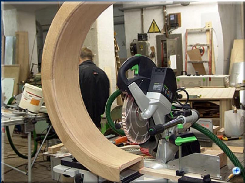
Установив небольшой деревянный брусок в качестве упора и ограничив глубину торцевания, подрезаем поверхность арочного свода под размер архивольта.
