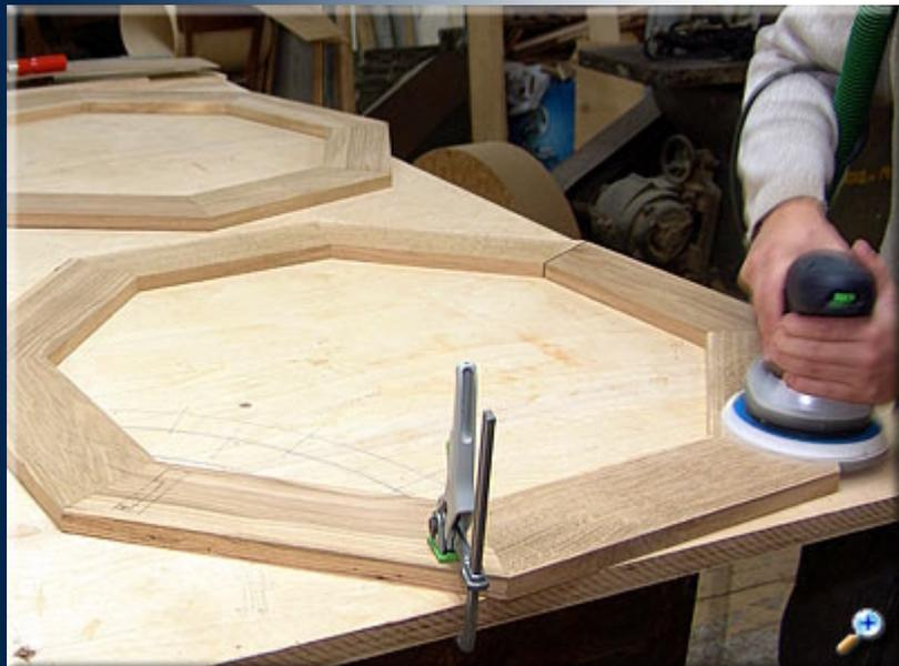
Удаляем остатки высохшего клея и шлифуем поверхность.
