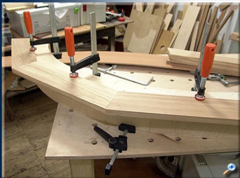
Склеиваем все детали и оставляем в таком положении до полного высыхания клея.
