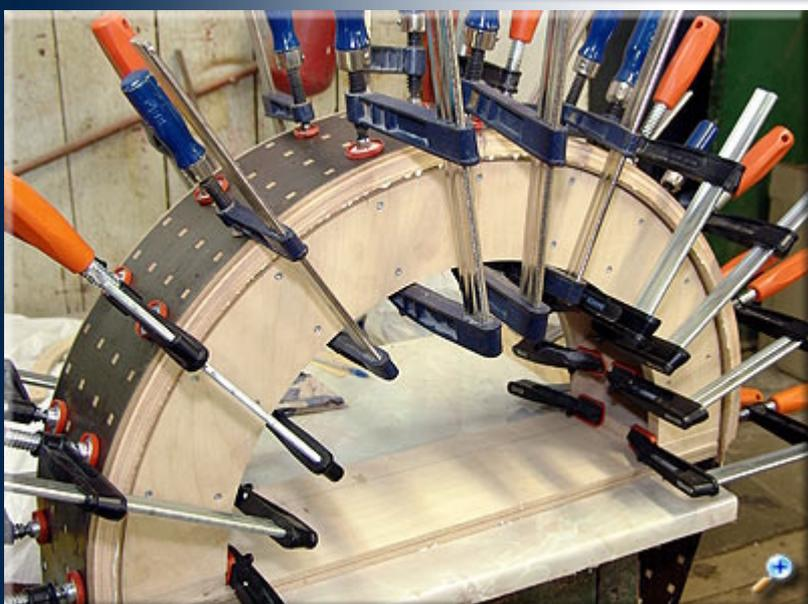
Форма готова, можно выклеивать заготовку. В данном случае применялась фанера и лист шпона 2,5мм. Наносим клей, фиксируем заготовку струбцинами и оставляем в таком положении до полного высыхания.
