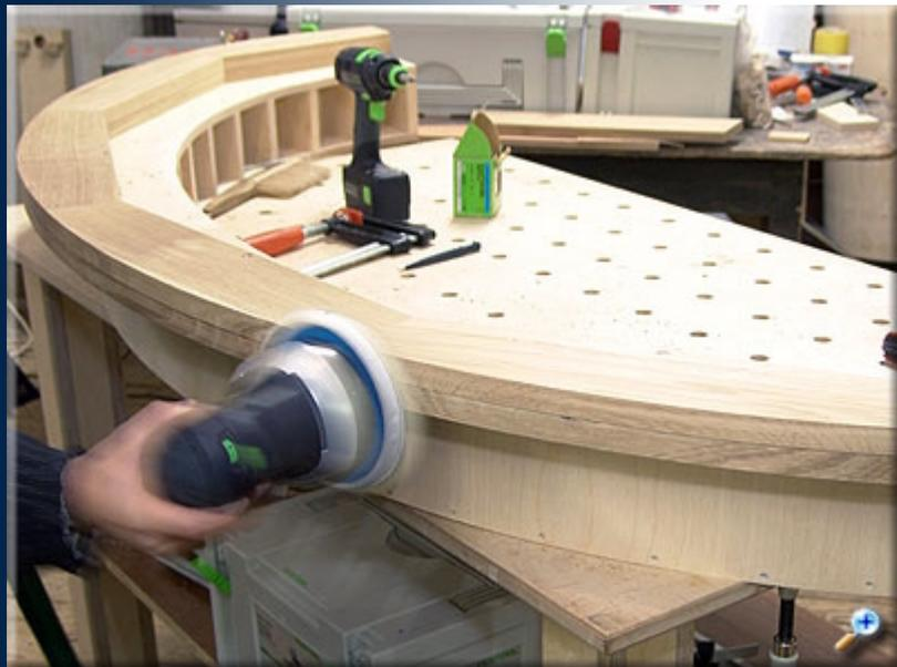
Теперь, когда внешние кромки у обеих деталей сформированы, производим окончательную шлифовку.
